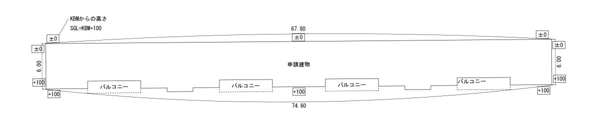
平均地盤の算定 建物周長 sig. L= 6.00 + 74.60 + 6.00 + 67.80= 154.40m 面積 A=6.0x0.05 + 74.60x0.10 + 6.0x0.05 + 67.80x0= 8.06m2 平均地盤の高さ(KMBから) Δh= 8.06/154.4= 0.05m(SGL-50とする)
